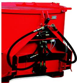
**ME200H** : Commande électrique du vérin D.E. pour l'ouverture et la fermeture de la trappe de vidange
